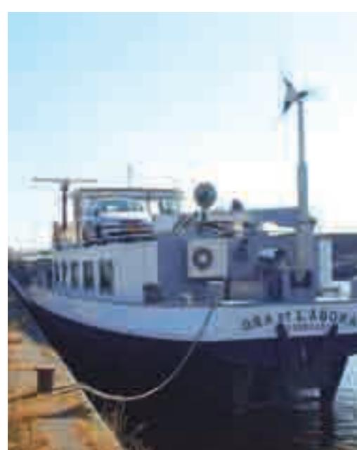
De windgenerator kan worden gebruikt tot stormkracht (windkracht 9).
